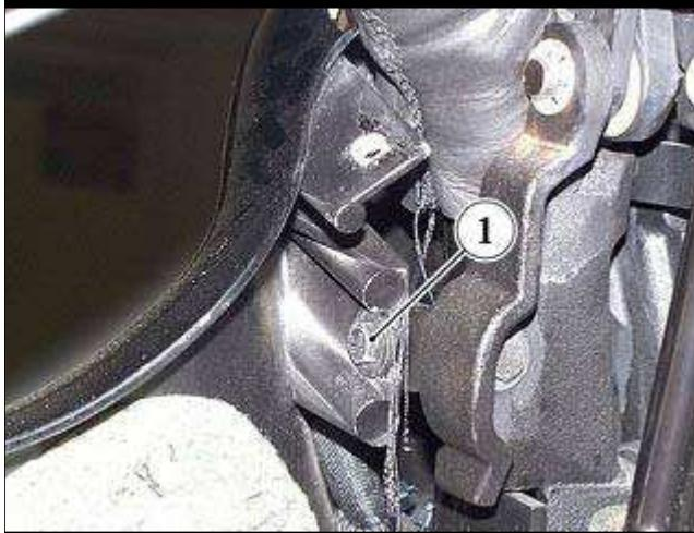
● 松开将防翻滚保护杆前盖固定到软顶框架侧面的两个螺钉 (1)。
