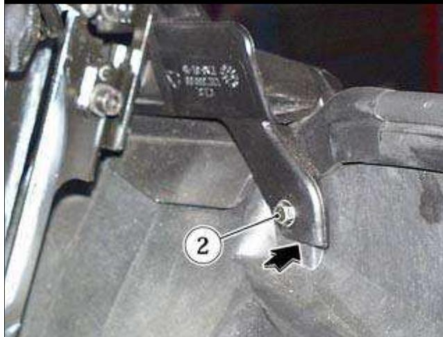
● 将两个紧固螺钉**(2)**安装到机架内, 确保参考标记对应; 将其一直拧入, 但是不要拧紧。
