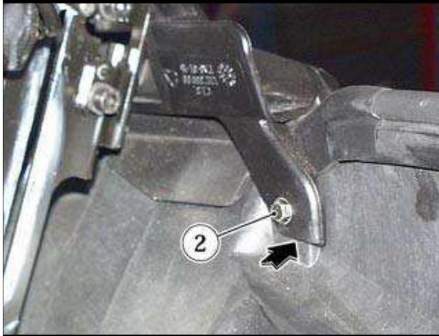
● 在软顶凹窝内侧, 标出防翻滚保护杆前盖延伸部分的位置。
