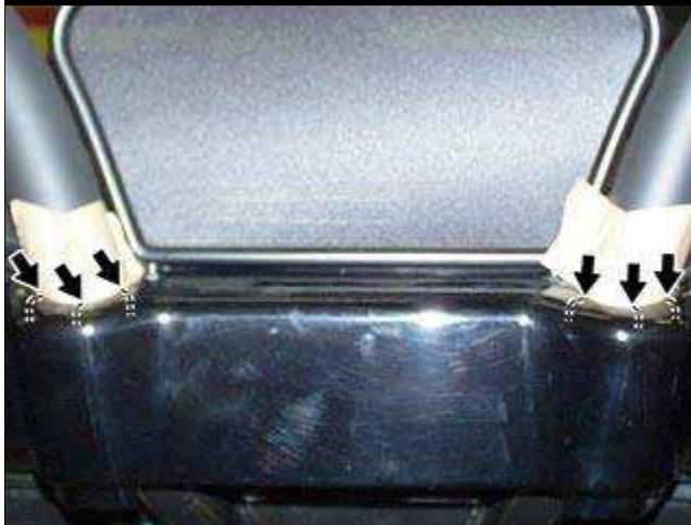
● 检查并确认前盖的位置对应拆卸过程中在防翻滚保护杆上所做的参考标记。
