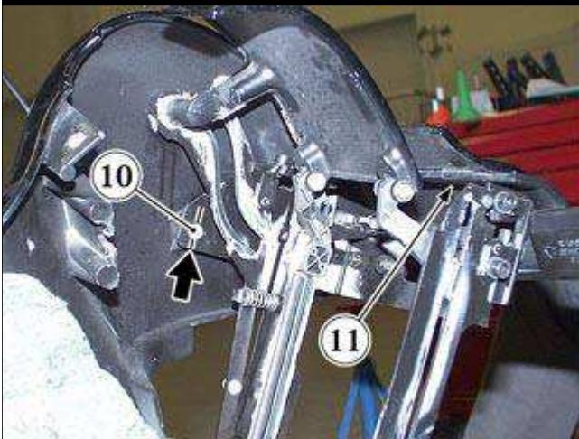
● 活门支撑有与前部 (10) 和后部紧固螺钉 (11) 对齐的槽; 在继续进行之前, 标出支撑相对于最内侧紧固螺钉 (10) 的位置。
