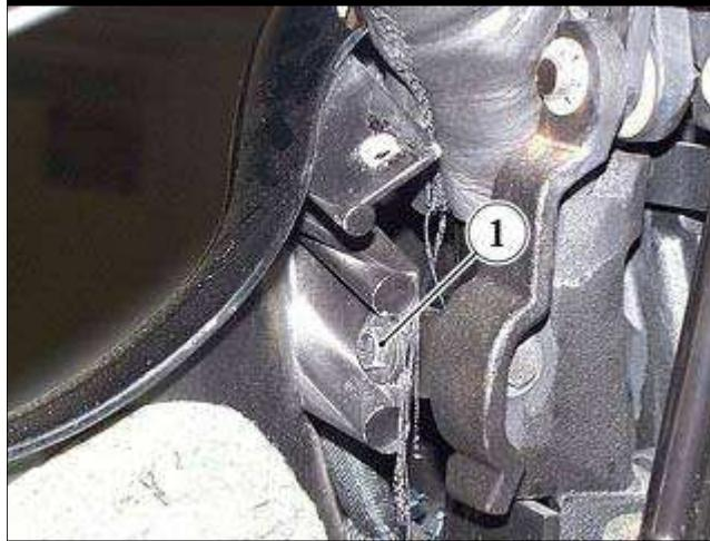
● 将盖支撑延长件安装到侧面螺钉 **(1)**, (首先将其松开) 并检查和确认它与拆卸过程中所做的参考标记对正。
