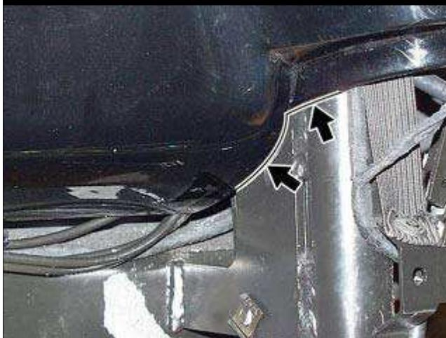
● 检查并确认前盖的位置对应拆卸过程中在软顶构架上所做的参考标记。
