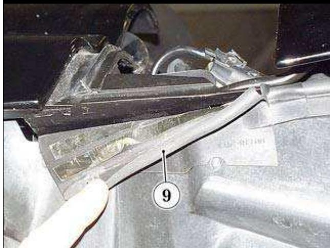
■ 将加工好外形的密封圈(9)安装在防翻滚保护杆前盖后端，并在必要时更换双面胶带。
