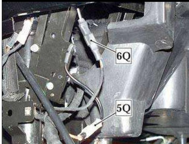
● 在拆卸热缩塑料包护套之后, 从活门微动开关上分离软顶系统“白色”插头 (5Q) 和 (6Q)。
