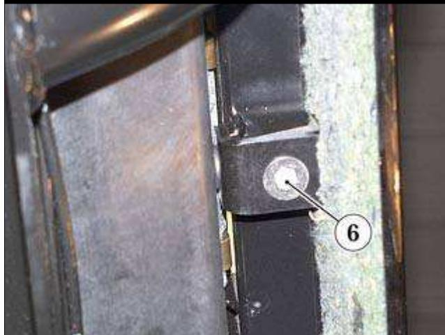
● 将螺钉 **(6)** 安装在至软顶构架的防翻滚保护杆前盖中心，不用拧紧。
