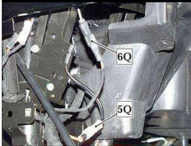
● 将软顶系统的白色插头 **(5Q)** 和 **(6Q)** 连接至其相应的活门位置微动开关，并使用缩管保护。
